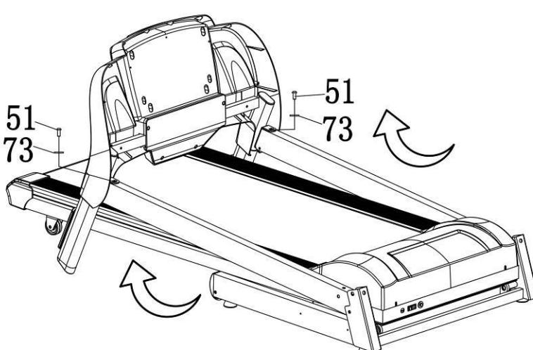
Придерживая раму компьютера, используйте 5# шестигранный гаечный ключ (12), винты M8\*16 (51) и стопорную шайбу (73) - закрепите корпус компьютера в вертикальном положении. Как показано на рисунке.
