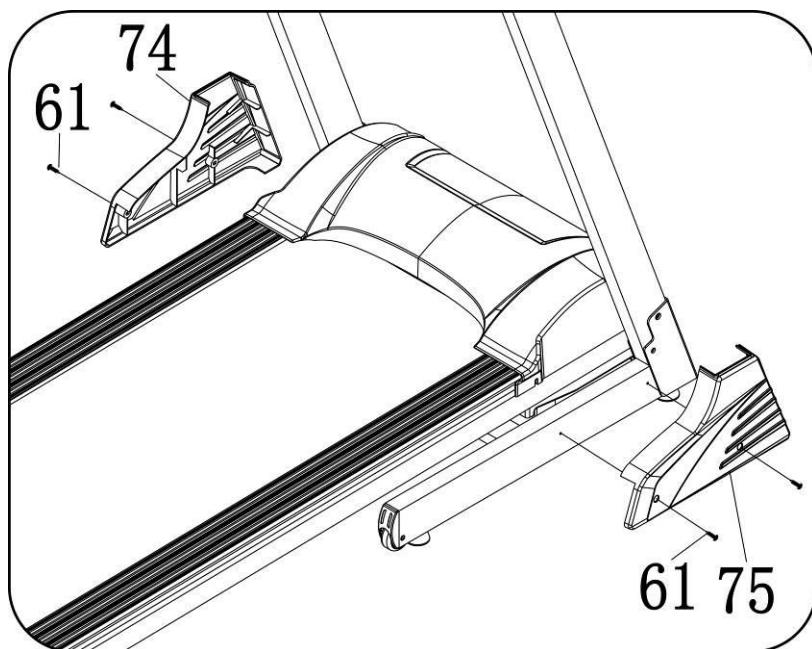
Используйте гаечный ключ с отверткой(46), чтобы прикрепить кожухи(74,75) к основной раме винтами ST4.2\*19 (61)
