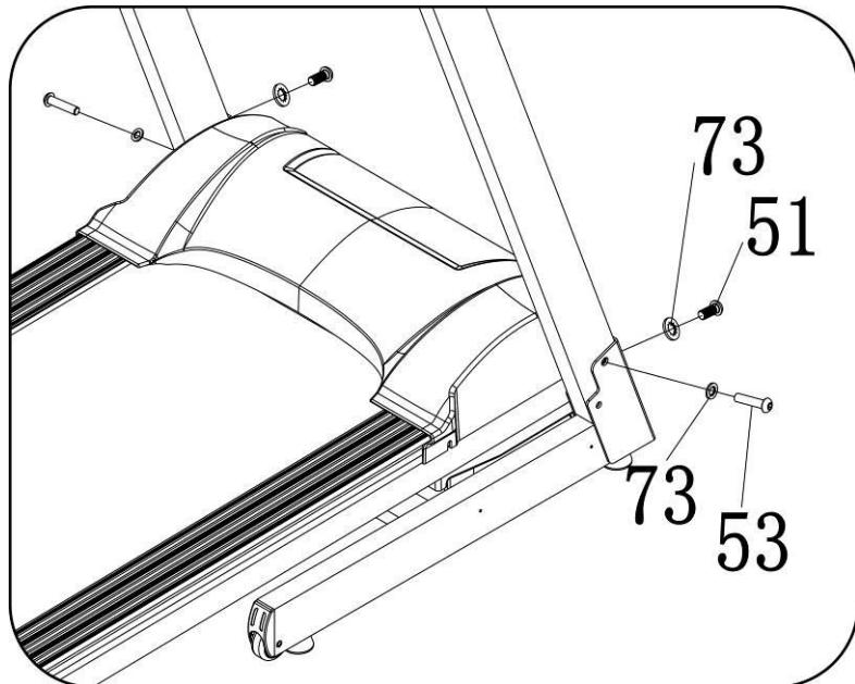
Используйте шестигранный гаечный ключ 5#, чтобы прикрепить вертикальные стойки к основной раме винтами M8\*45(53), M8\*16(51) и шайбами(73).
