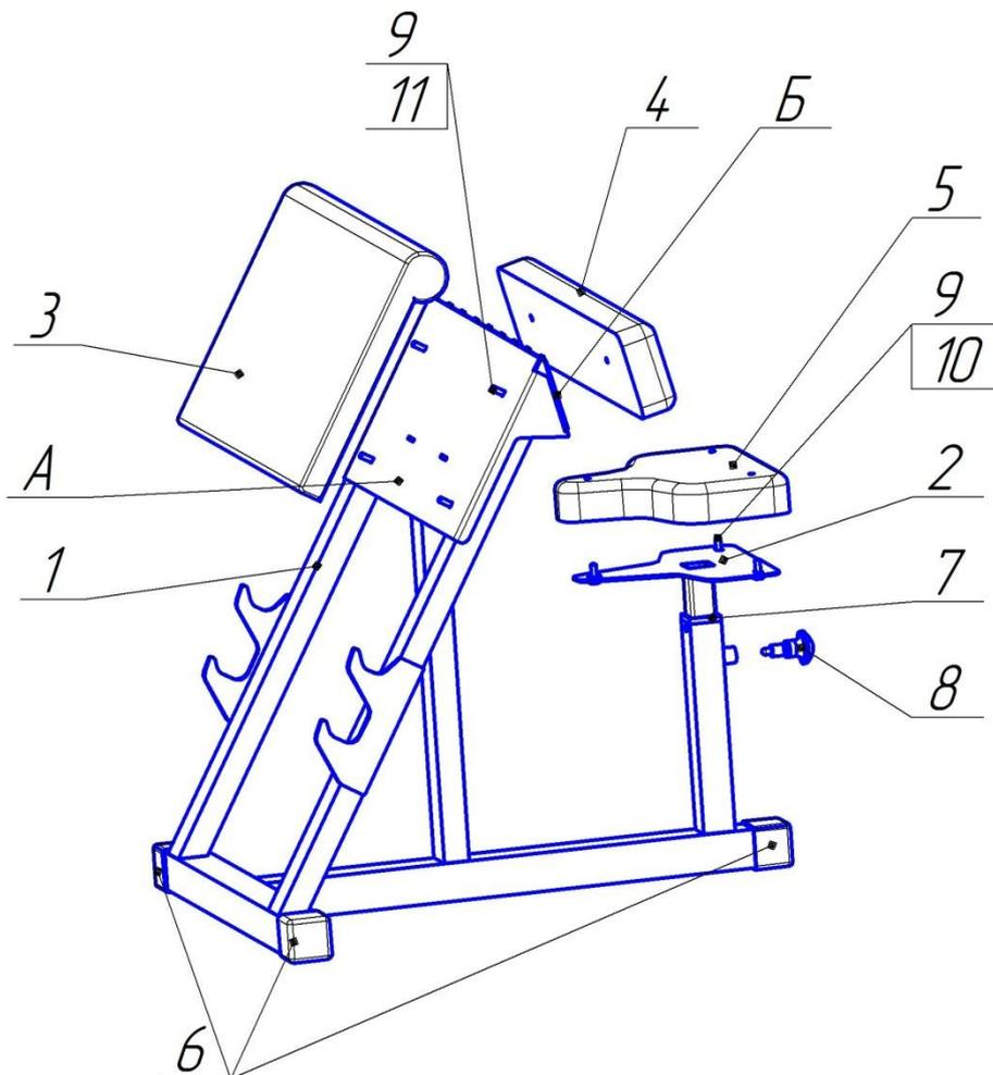
Рис. 4. Схема сборки тренажера.
