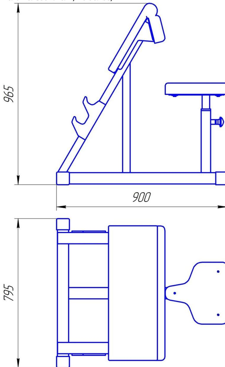
Рис. 2. Габаритные размеры тренажера.
